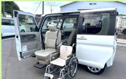
電動で助手席が回転し、車外へスライドダウンします。シートは任意の高さで止めることができます。
